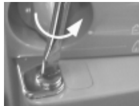
1. Tür öffnen, Scharnierschraube lösen und aufbewahren.
