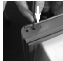
12. Türverriegelungsstab mit Feder auf entgegengesetzter Seite einführen.
