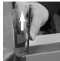
8. Verriegelungsstab mit Feder herausziehen.
